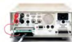
Установка платы сканера превращает любой из этих цифровых мультиметров в готовую измерительную систему.
