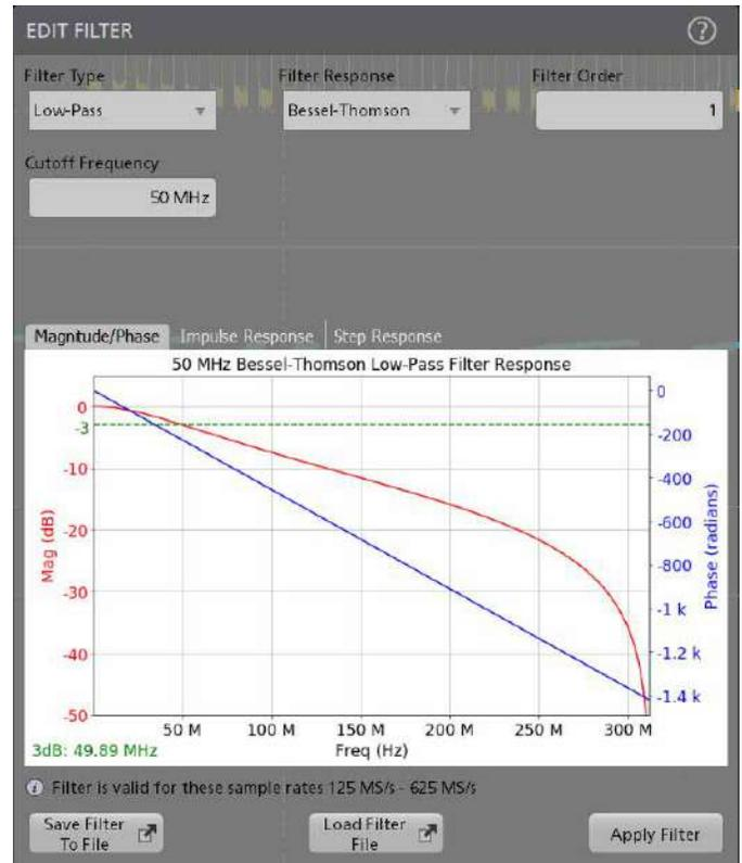
Диалоговое окно создания фильтра с опциями «Тип фильтра», «Характеристика фильтра», «Частота среза», «Порядок фильтра», а также графиками амплитудно-фазовой, импульсной и переходной характеристики.
