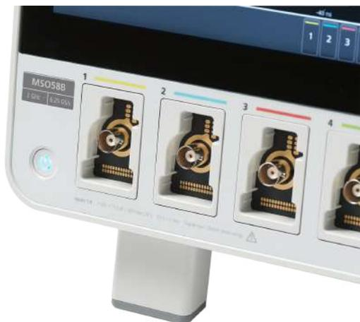
*Уникальная гибкость конфигурации за счет технологии FlexChannel. Каждый вход, в зависимости от типа подключенного пробника, можно настроить как один аналоговый или восемь цифровых каналов.*
