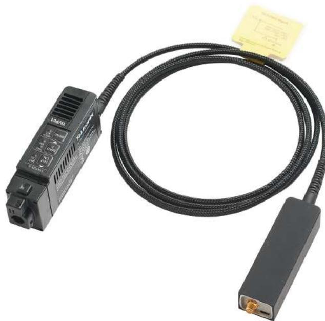
Измерительная система IsoVu™ серии TIVP компании Tektronix — это комплект оснастки с гальванической развязкой для высокоточных измерений широкополосных дифференциальных сигналов с амплитудой до 2500 Впк в присутствии больших синфазных сигналов. Система отличается самым высоким в этом классе приборов коэффициентом подавления синфазного сигнала по всей полосе пропускания.
