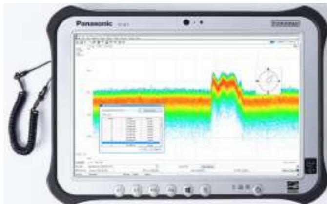
Приобретаемый у Tektronix планшет FZ-G1 имеет установленное ПО SignalVu-PC, а также специальные настройки экрана и кнопки передней панели для оптимизации работы с SignalVu-PC.
