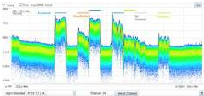
На рисунке выше представлено типовое исследование сигнала. В данном случае исследуется часть полосы телевизионного вещания, в которой выделено 7 областей. Каждая область маркирована определенным цветом и обозначена как Разрешенная, Неизвестная или Запрещенная.
