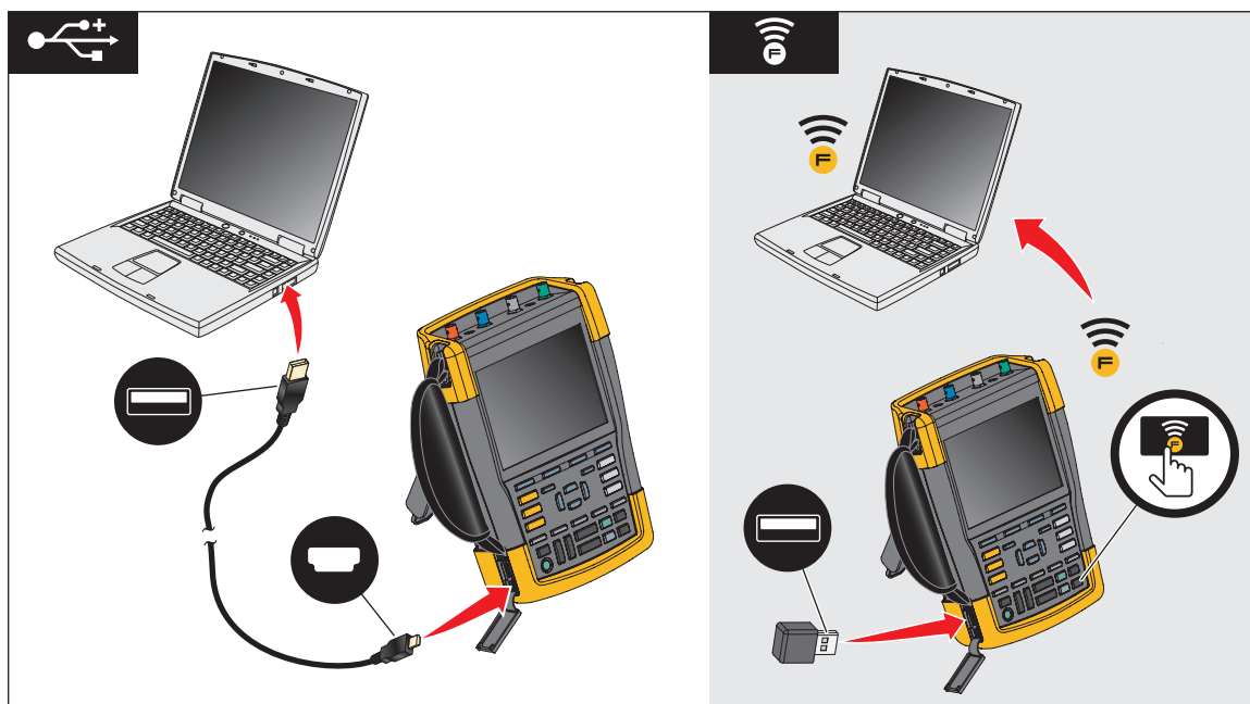
Рис. 32. Подключение к компьютеру
