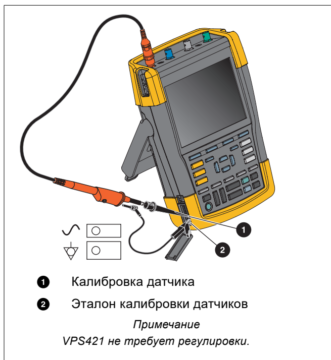
Рис. 48. Регулировка датчика напряжения
