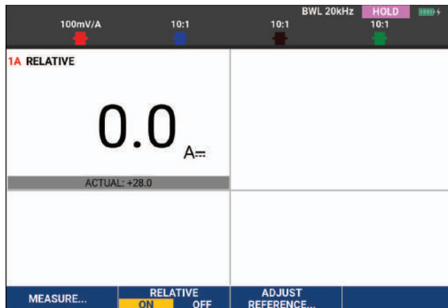
Рис. 11. Проведение относительного измерения
