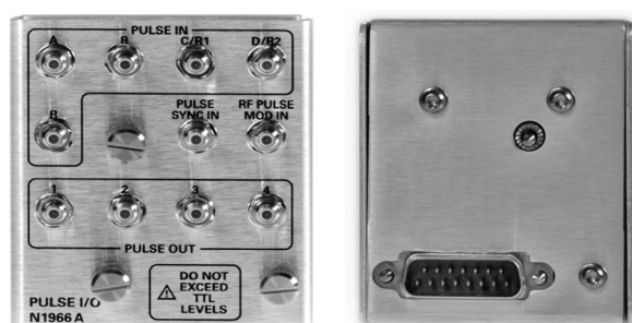
Адаптер импульсного ввода/вывода (N1966A) облегчает подключения
