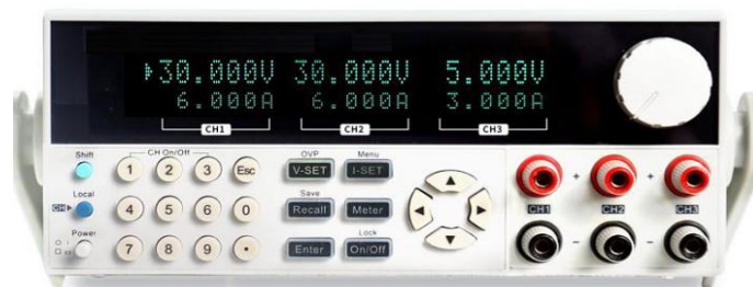
Вариант исполнения TL3-30-6 30В/6А * 2 канала, 6В/3А *1 канал
