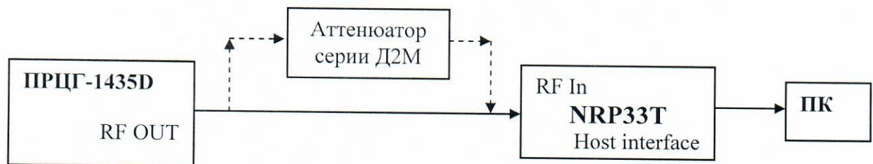
Рисунок 2 – Структурная схема соединения СИ для определения абсолютной погрешности установки уровня выходного сигнала с помощью NRP40T
