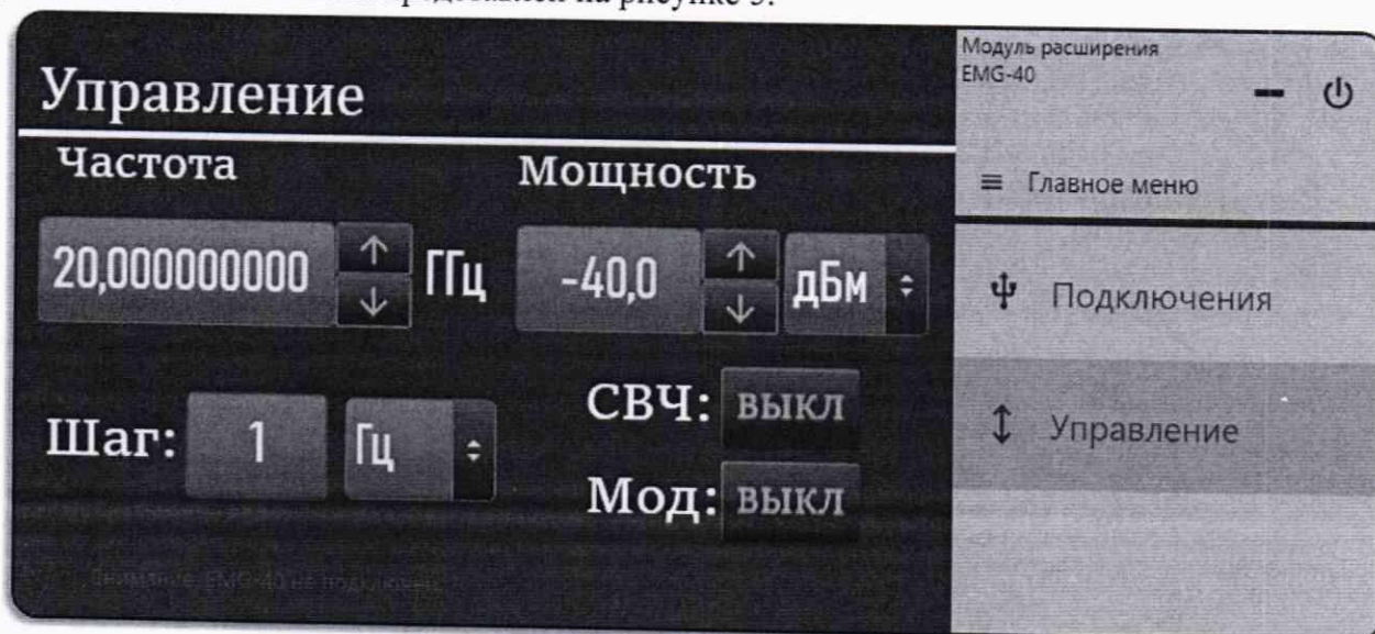
Рисунок 5 – Окно установки уровней частоты и выходного сигнала
