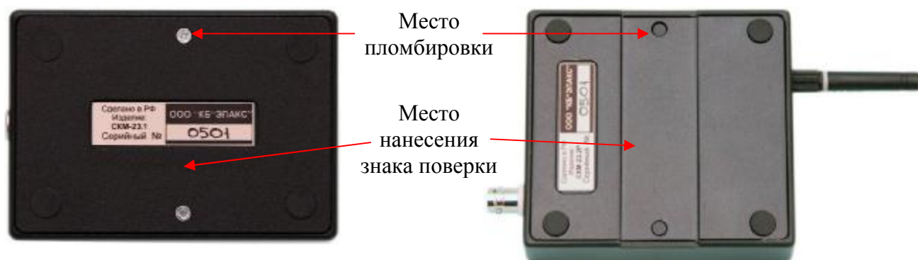
Рисунок 2 - Схема пломбировки от несанкционированного доступа и место нанесения знака поверки
