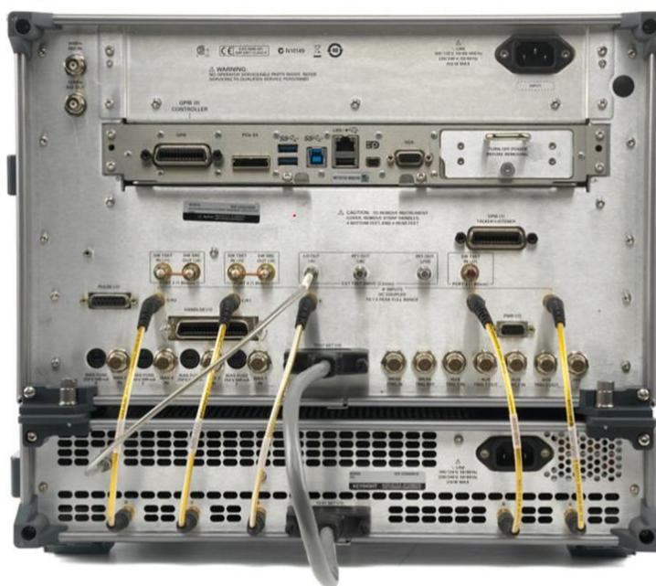
Рисунок 2 – Система анализа цепей векторная N5290A, N5291A, вид сзади
