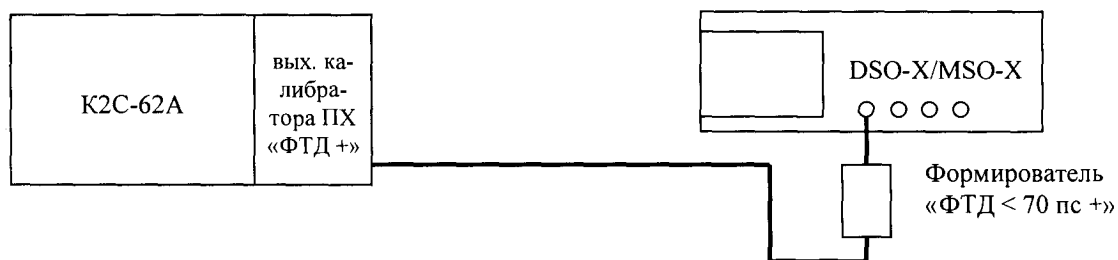
Рисунок 3 – Схема определения полосы пропускания
