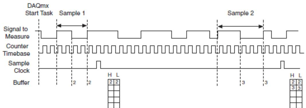
Рисунок 3-10 Измерение длины импульса. Измерение по сигналу дискретизации.
