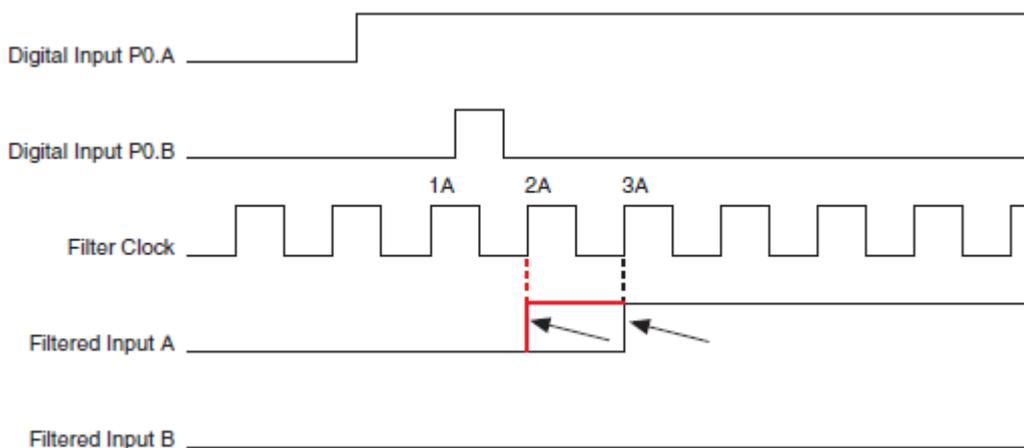
Рисунок 2-16 Разница между фильтрацией по линии и фильтрацией по шине
