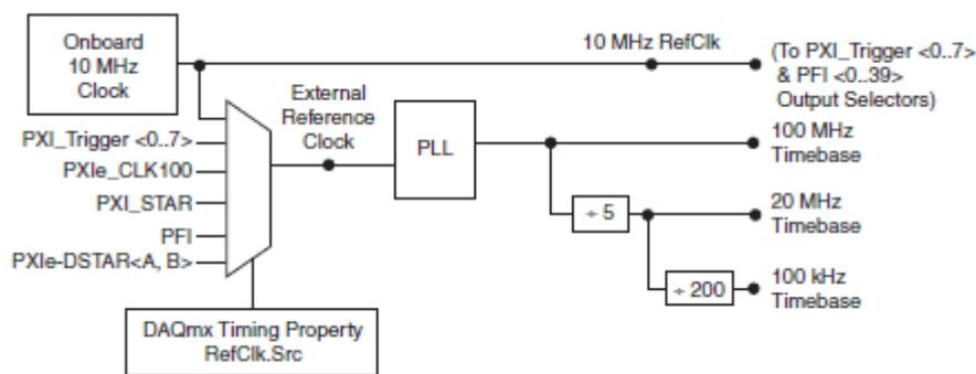
Рисунок 5-16 Схема маршрутизации тактовых сигналов NI 6614
