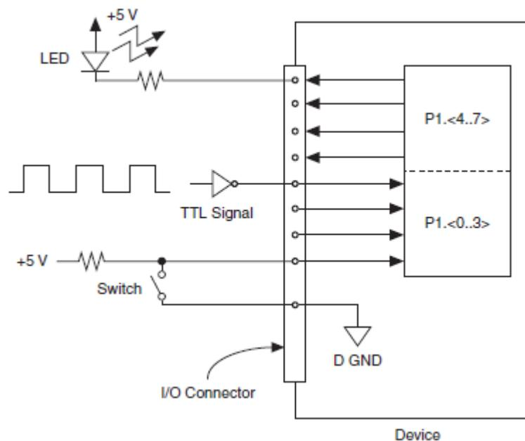
Рисунок 2-17. Схема подключения внешних устройств к линиям ввода-вывода
