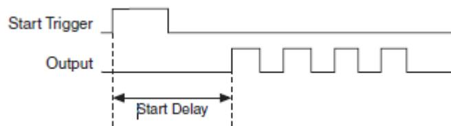
Рисунок 3-36 Сигнал Start Trigger запускает генерацию импульса
