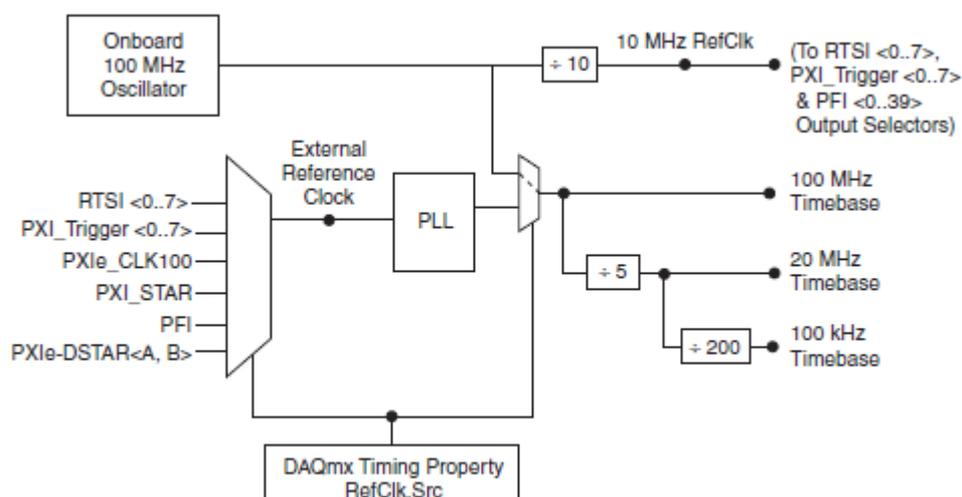
Рисунок 5-1а Схема маршрутизации тактовых сигналов NI 6612
