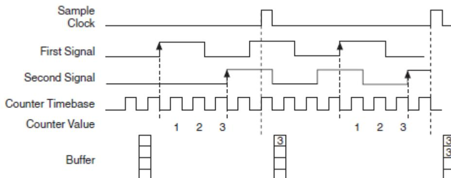
Рисунок 3-26 Измерение интервала времени с синхронизацией по сигналу дискретизации
