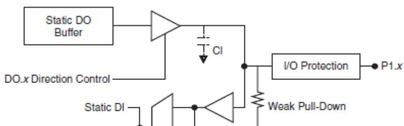
Рисунок 2-2 схематика линии цифрового ввода-вывода на порту 1
