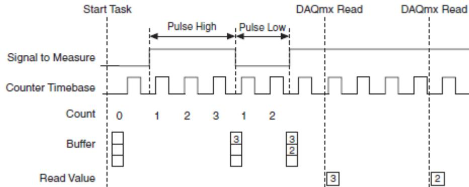
Рисунок 3-12 измерение полупериода
