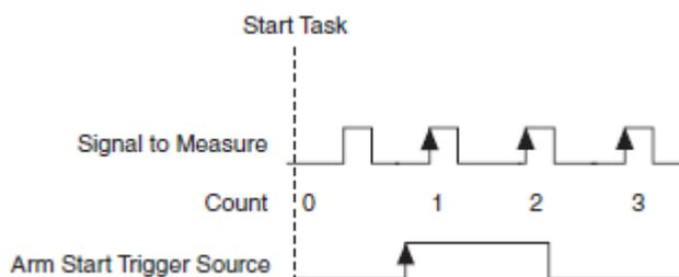
Рисунок 3-5 Счет фронтов. Использование Arm Start Trigger
