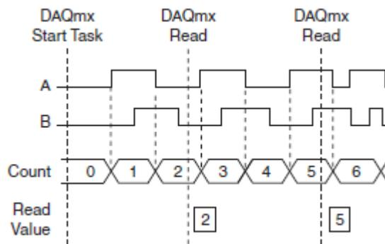
Рисунок 3-32 Угловая координата: Синхронизация с выдачей по запросу
