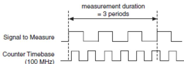
Рисунок 3-14 Измерение частоты используя фиксированное число периодов
