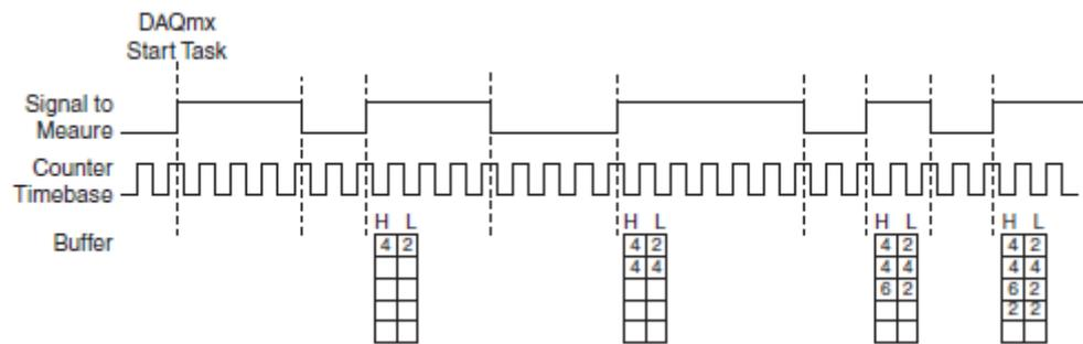
Рисунок 3-9 Измерение длины импульса. Неявная синхронизация
