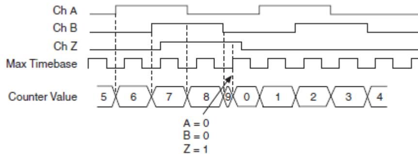
Рисунок 3-30 Перезагрузка по каналу Z с кодировкой X4.
