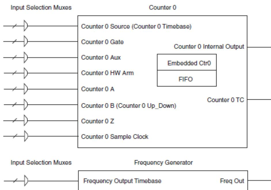
Рисунок 3-1 Счетчик номер 0 и генератор частот
