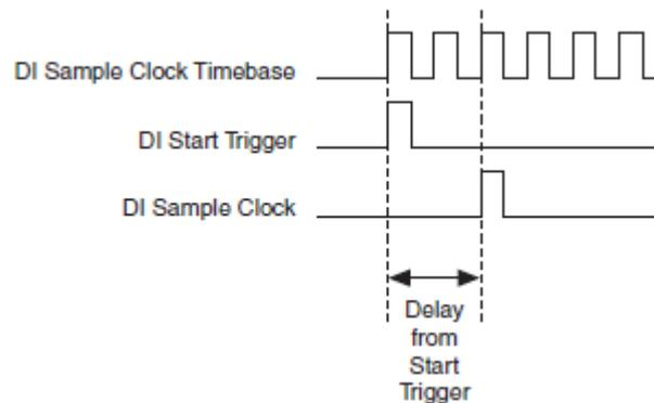
Рисунок 2-4 Временные соотношения между сигналами DI Sample Clock и DI Start Trigger
