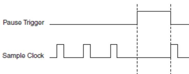
Рисунок 2-10 Сигнал DO Pause Trigger с внутренней синхронизацией приостановки снимается (рис. 2-10).
