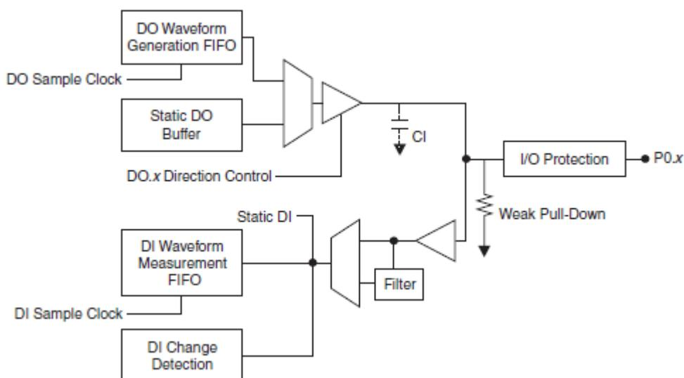
Рисунок 2-1 схематика линии цифрового ввода-вывода на порту 0
