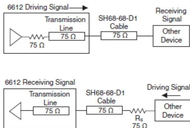
Рисунок 4-4 Параллельное и последовательное подключение оконечной нагрузки
