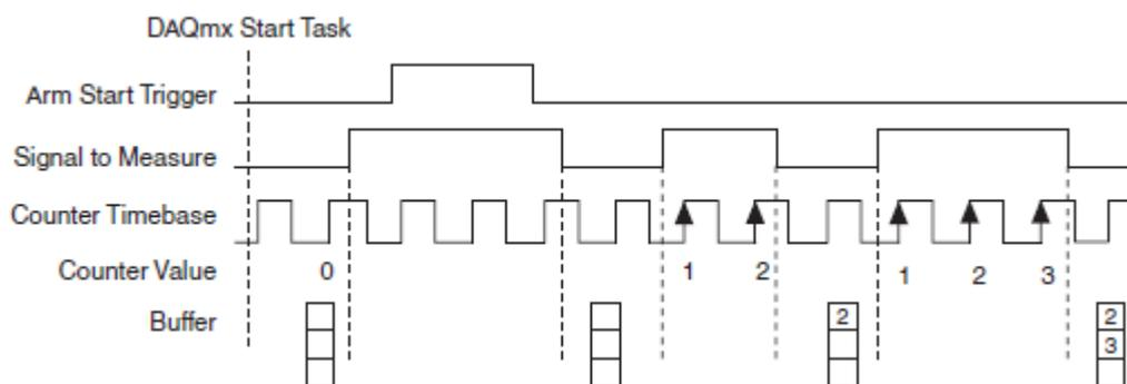
Рисунок 3-21 Измерение ширины импульса. Неявная синхронизация
