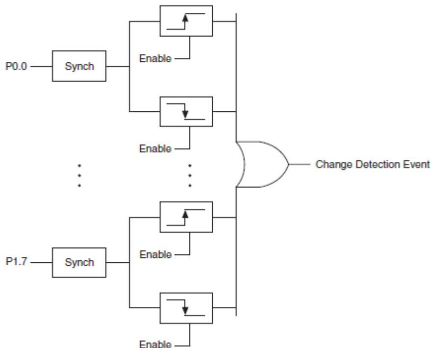
Рисунок 2-12 Схема обнаружения изменения сигналов на линиях ввода-вывода
