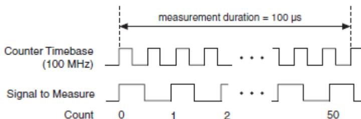
Рисунок 3-13 Измерение частоты, используя фиксированное время измерения
