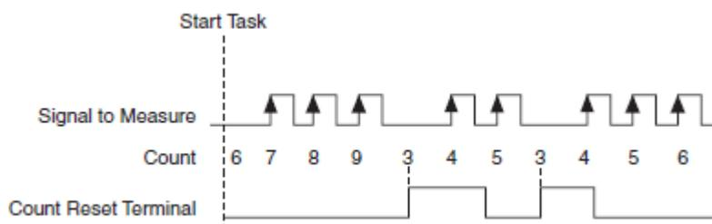
Рисунок 3-7 Пример использования Reset Trigger для счета фронтов
