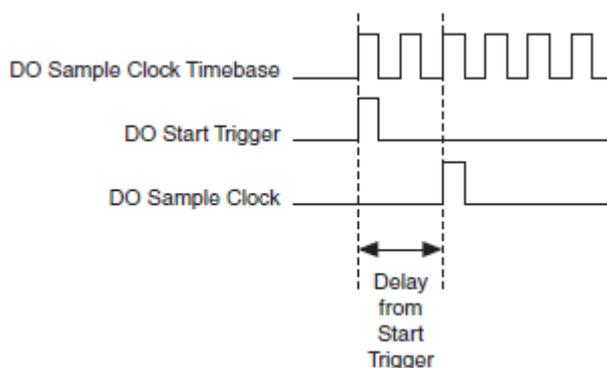
Рисунок 2-8 Временные соотношения между сигналами цифрового вывода
