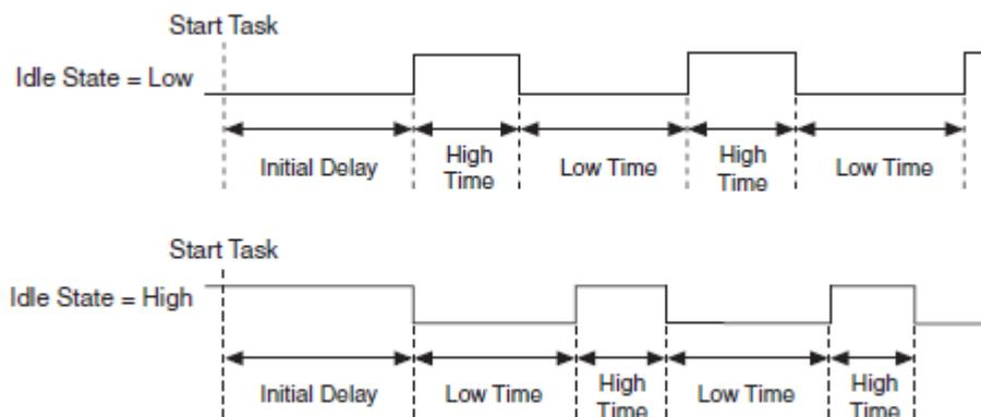
Рисунок 3-35 Параметры импульсов
