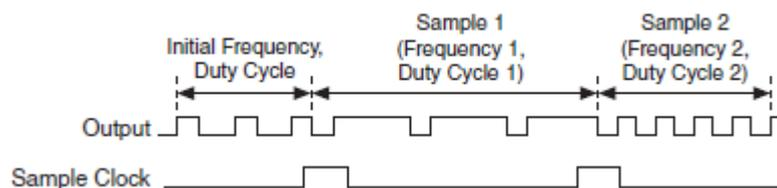
Рисунок 3-40 Сигнал с переменной частотой и коэффициентом заполнения
