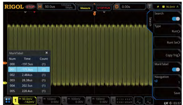
Функция поиска и навигации позволяет быстро находить сигналы с особенностями и точно определять их местоположение.
