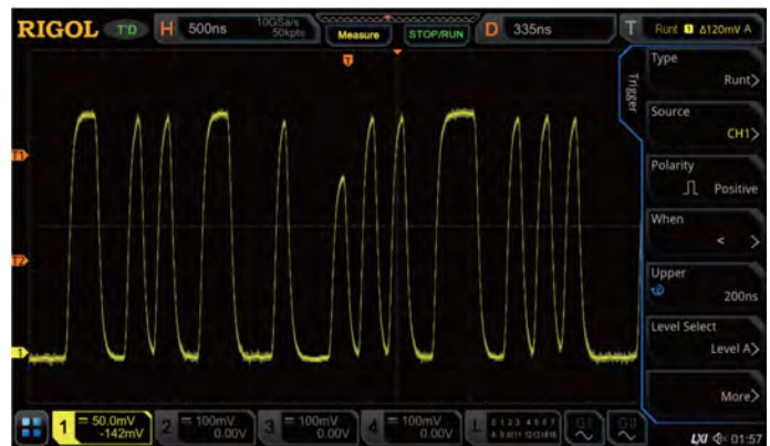
Запуск по импульсу нетипичной амплитуды поможет захватить нужный сигнал в последовательности импульсов.
