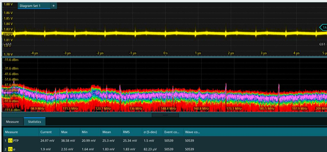
Использование анализа спектра вместе со стробированием по времени в целях эффективного поиска источников, влияющих на шум шины питания.
