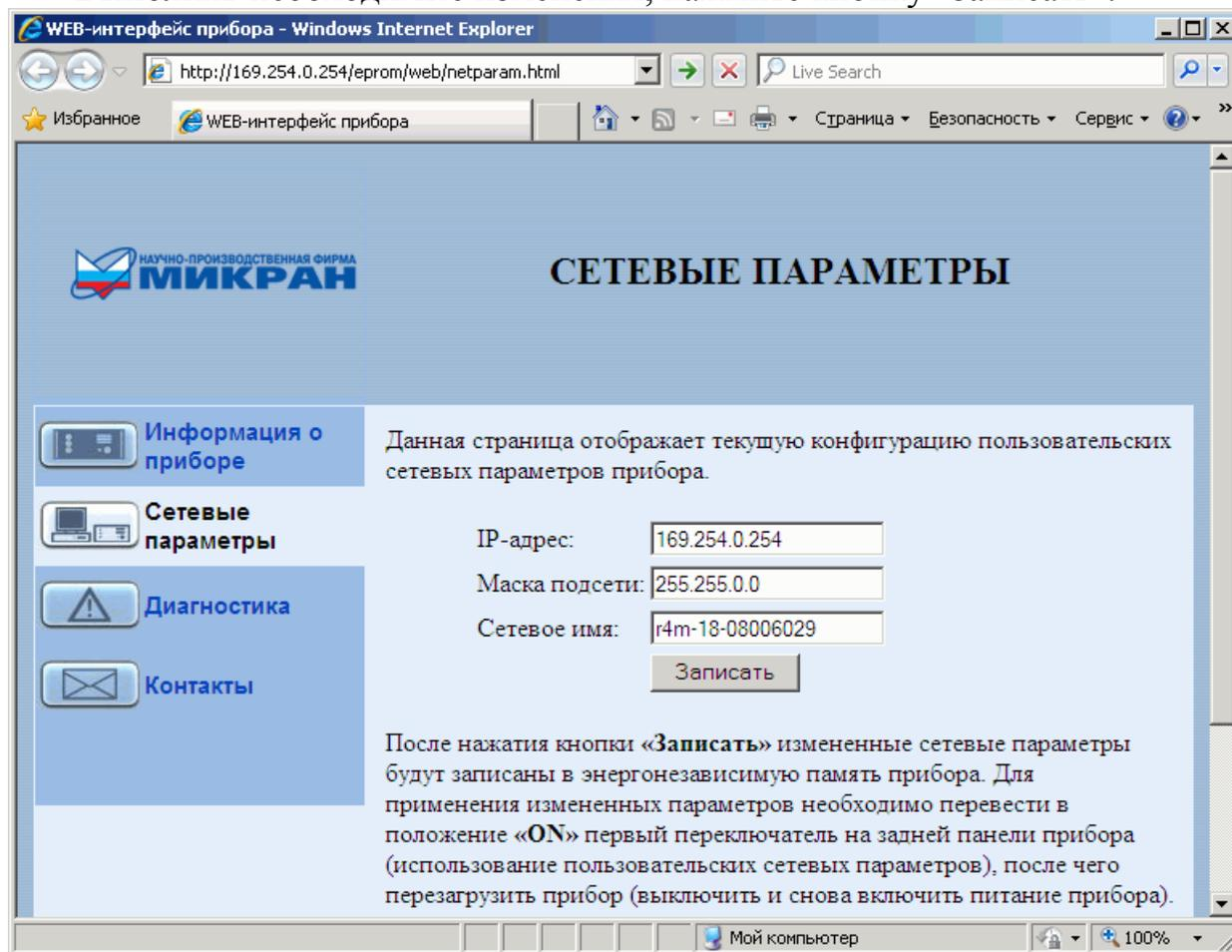
Рисунок 2.5 – Изменение сетевых параметров (для прибора Р4М)
