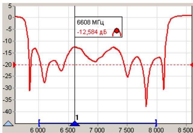
Рисунок 3.27 – Следящий маркер
