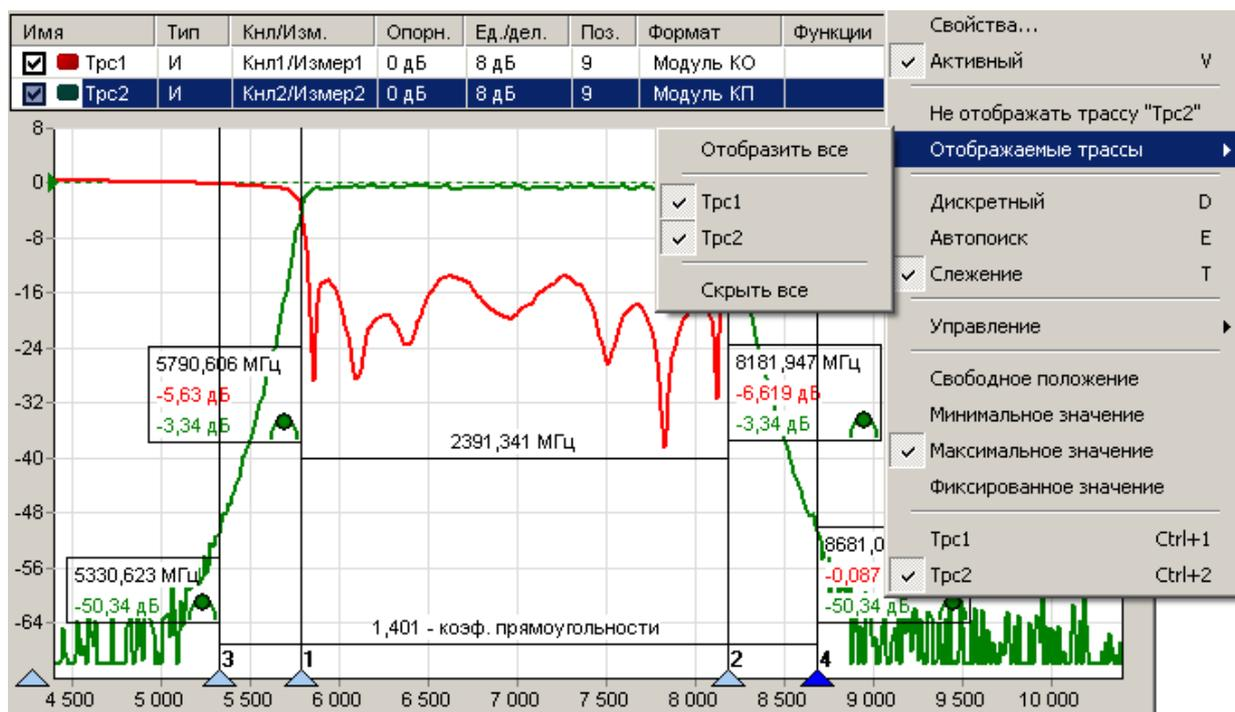
Рисунок 3.25 – Использование маркеров
