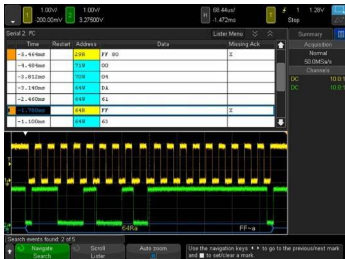
Рисунок 11. Используя функцию поиска условий ошибки, 4000 X-Series быстро нашел 5 мест с отсутствующим подтверждением в последовательной шине I²C. Функция навигации перемещается между ошибками и автоматически масштабирует изображение, чтобы показать пакет ошибок.
