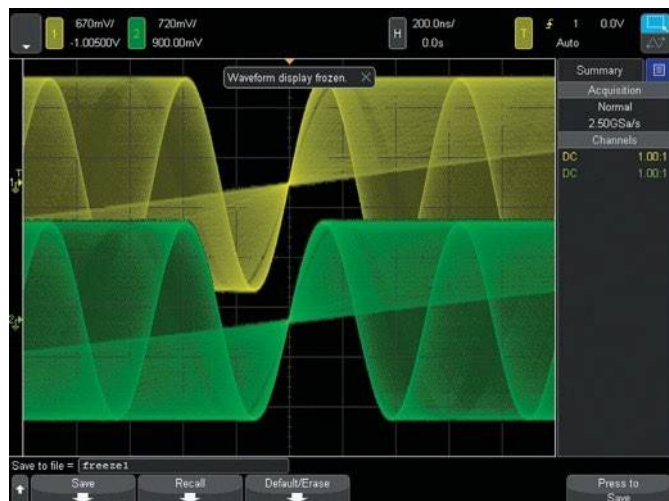
Рисунок 42. Функция "замораживания экрана" сохраняет информацию о градации интенсивности, останавливая получение осциллограмм.
