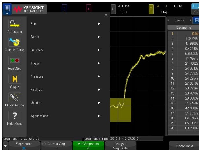
Рисунок 14. Используйте выпадающее меню Keysight для работы в стиле Window.
