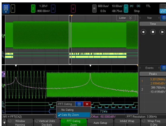
Рисунок 18. БПФ с пропусками успешно коррелирует скачки FSK-модуляции с аналоговой и I^2C управляющей командой.
