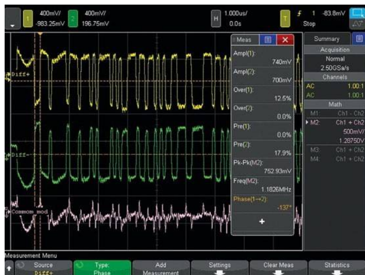
Рисунок 24. Двухканальный выход WaveGen дифференциальных произвольных сигналов. Общий режим показан в виде математики.
