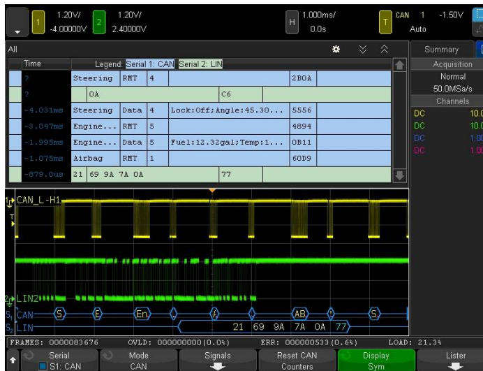
Рисунок 20. Двойная последовательная шина CAN и LIN с декодированием и чередующимся отображением "списка".
