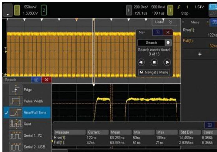
Рисунок 10а. Осциллограф серии 4000 X был настроен на захват сигналов данных с различными фронтами времени нарастания. Используя возможности поиска и навигации, осциллограф смог найти, отметить (белые треугольники) и быстро перейти к 16 случаям "несоответствующего" времени нарастания
