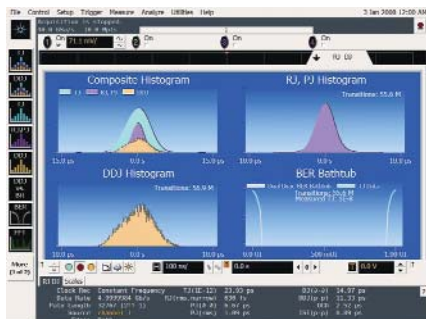
Анализ джиттера плюс выделение RJ/DJ
