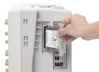
Быстрое извлечение накопителя на жёстких магнитных дисках с целью дополнительной защиты данных при использовании опции 801.
