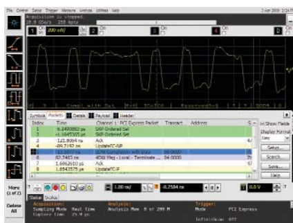
Запуск и декодирование пакетов последовательной шины PCIe
