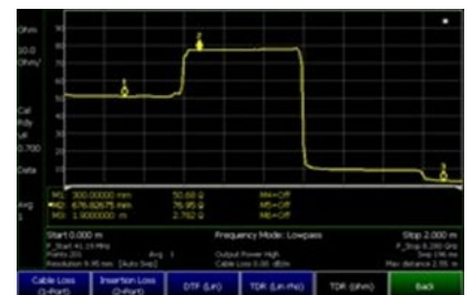
Получение информации о неисправностях с помощью измерений TDR
