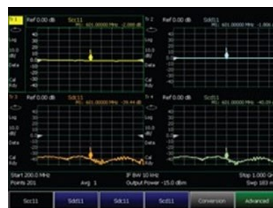
Характеризованные отражения общего и дифференциального режимов с помощью измерений S-параметров смешанного режима
