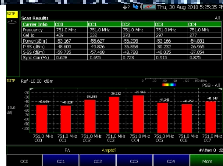
5GTF OTA поддерживает сети Verizon pre-5G, измеряет каналы управления и отображает идентификатор ячейки.
