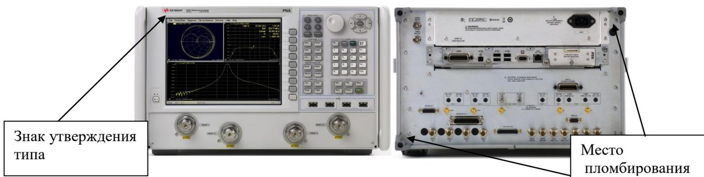
Рисунок 3 – Общий вид анализаторов цепей векторных N5221A, N5222A, N5224A, N5225A, N5227A
