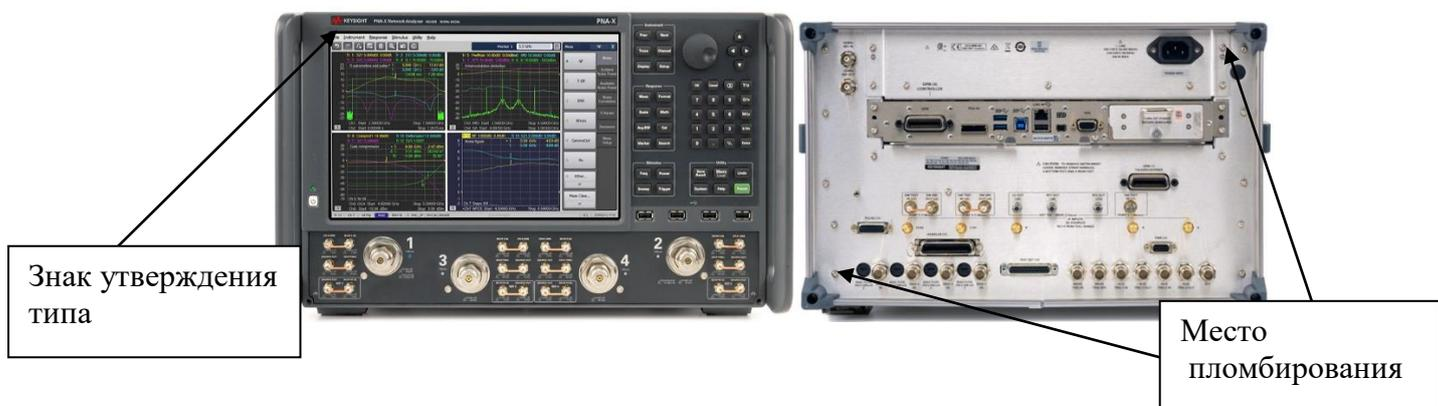
Рисунок 6 – Общий вид анализаторов цепей векторных N5241B, N5242B, N5244B, N5245B, N5247B
