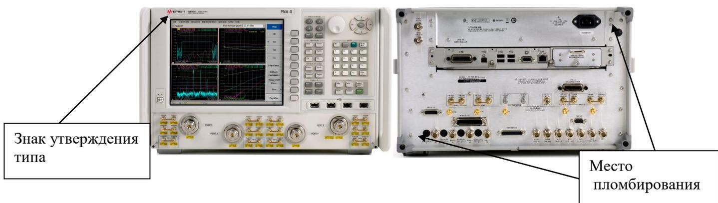
Рисунок 5 – Общий вид анализаторов цепей векторных N5241A, N5242A, N5244A, N5245A, N5247A
