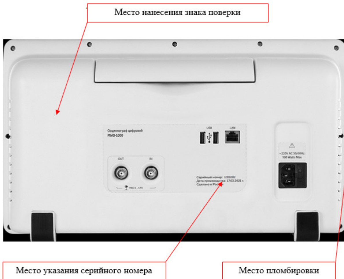
Рисунок 2 – Схема пломбировки от несанкционированного доступа, место нанесения серийного номера, идентифицирующего каждый экземпляр СИ, место нанесения знака поверки
