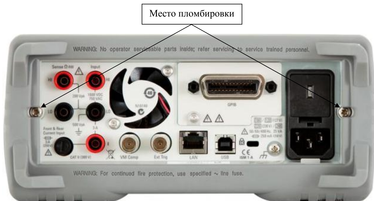
Рисунок 4 – Общий вид мультиметров цифровых 34461A. Вид сзади. Схема пломбировки от несанкционированного доступа
