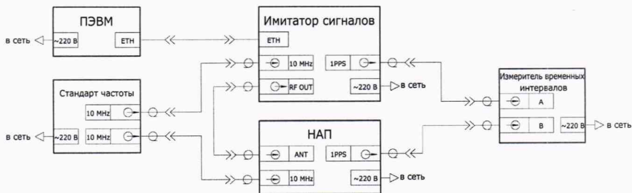
Рисунок 4 — Схема измерений для определения погрешности воспроизведения беззапросной дальности
