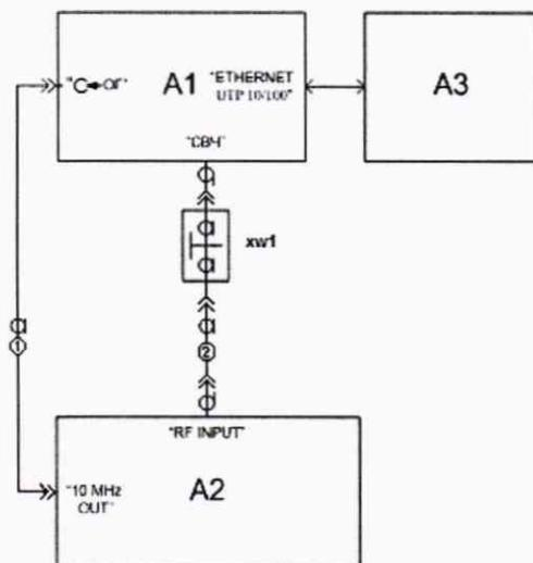
A1 – поверяемый Г7М-06; A2 – анализатор сигналов; A3 – ПК;
