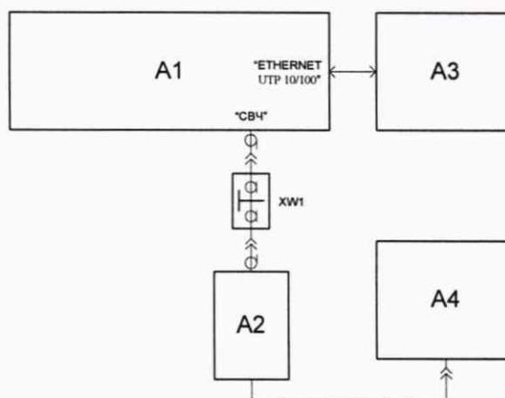
A1 – поверяемый Г7М-06; A2 – преобразователь измерительный ваттметра;
