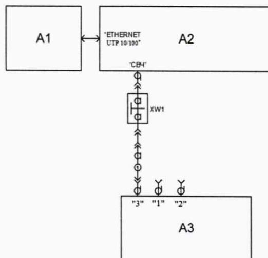
A1 – ПК; A2 – поверяемый Г7М-06; A3 – частотомер;
