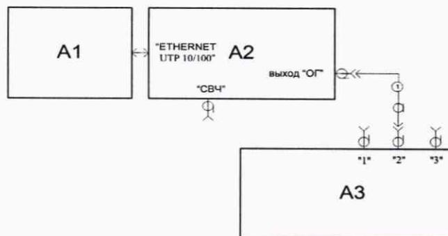
A1 – ПК; A2 – поверяемый Г7М-06; A3 – частотомер;
