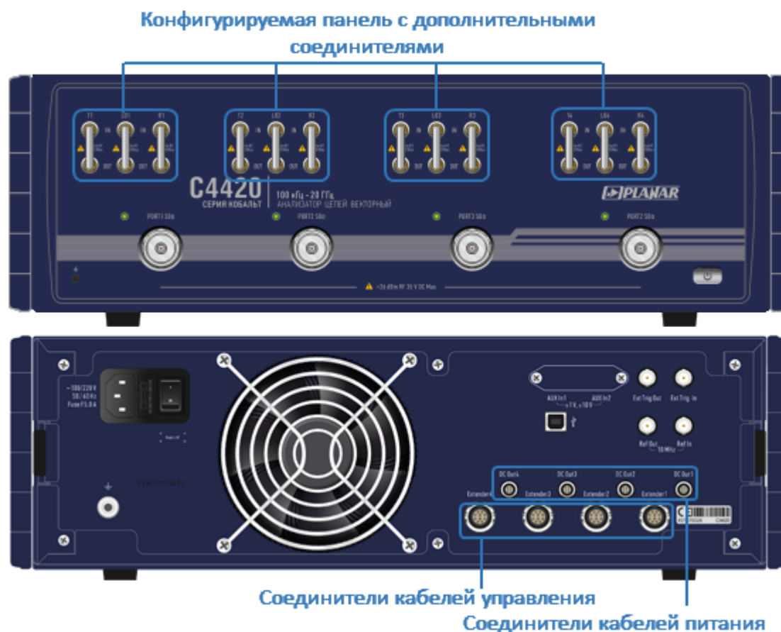
Рисунок 229 – Расположение дополнительных соединителей анализатора C4420
