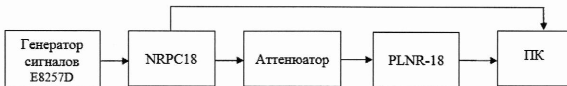
Рисунок 6 – Схема измерений для определения составляющей основной погрешности ваттметров, обусловленной нелинейной зависимостью их показаний от уровня измеряемой мощности
