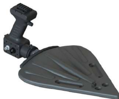
Специальная радиопеленгаторная антенна Alaris
