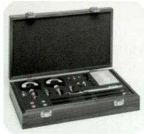
Рисунок 8 - Набор мер коэффициентов передачи и отражения 85056A
