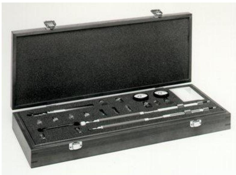
Рисунок 6 - Набор мер коэффициентов передачи и отражения 85052B
