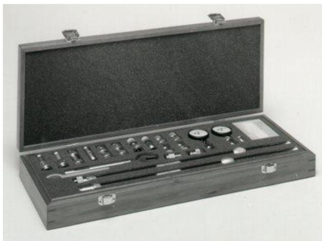
Рисунок 3 - Набор мер коэффициентов передачи и отражения 85054B
