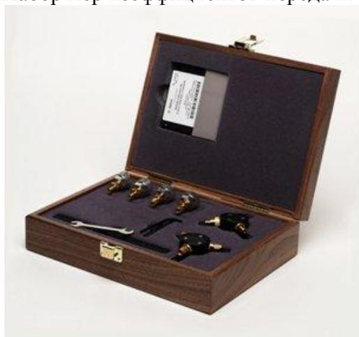
Рисунок 5 - Набор мер коэффициентов передачи и отражения 85033E
