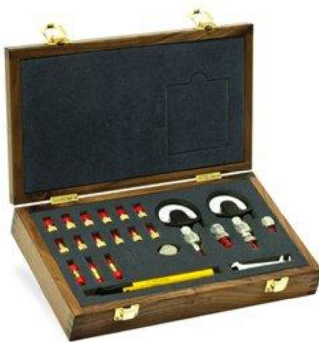
Рисунок 10 - Набор мер коэффициентов передачи и отражения 85058В
