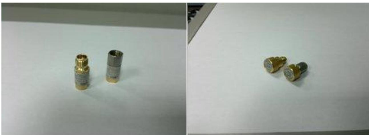
Рисунок 11 – Внешний вид мер коэффициентов передачи и отражения
