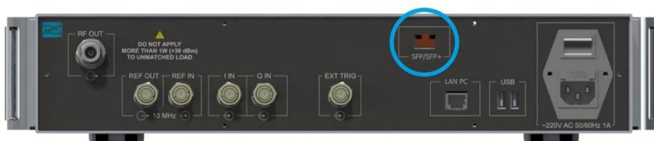
Рис. 1. Разъем SFP/SFP+ для управления прибором по Ethernet
