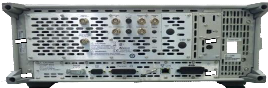
Рисунок 2 - Схема размещения наклеек от несанкционированного доступа
