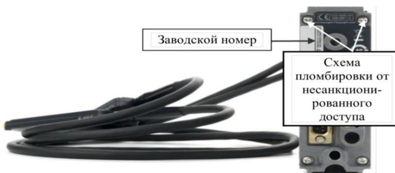
Рисунок 2 – Внешний вид модуля N1045B, вид сзади
